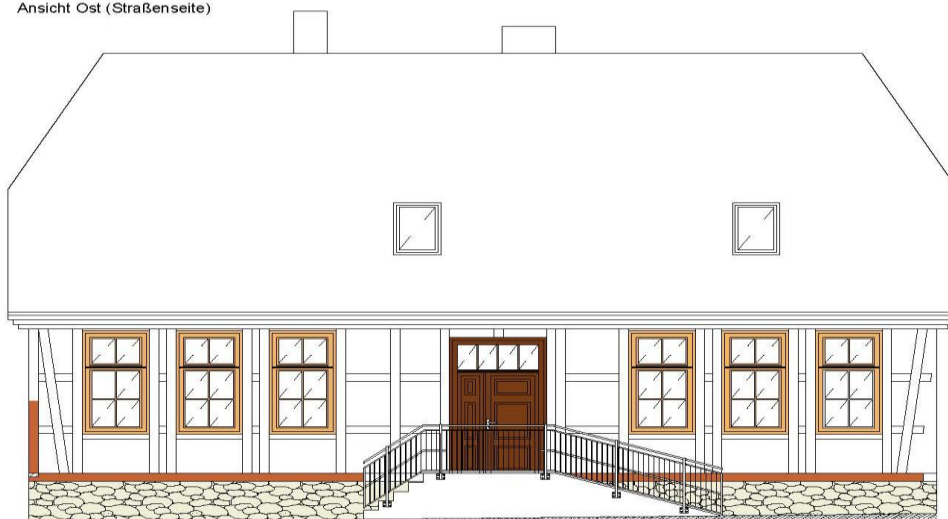
1. Gebäudesockel: - freigelegter Natursteinsockel, dieser tritt plastisch vor die Fassade
