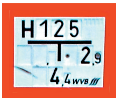
Hinweisschilder zum Auffinden von Hydranten
