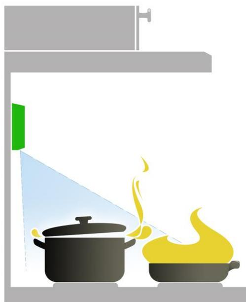
Wirksamer Schutz gegen Brandgefahr: Mit Sensoren überwacht die Herdabschaltung das Kochfeld. Bei ungewöhnlicher Hitzeentwicklung wird der Strom automatisch abgeschaltet.
